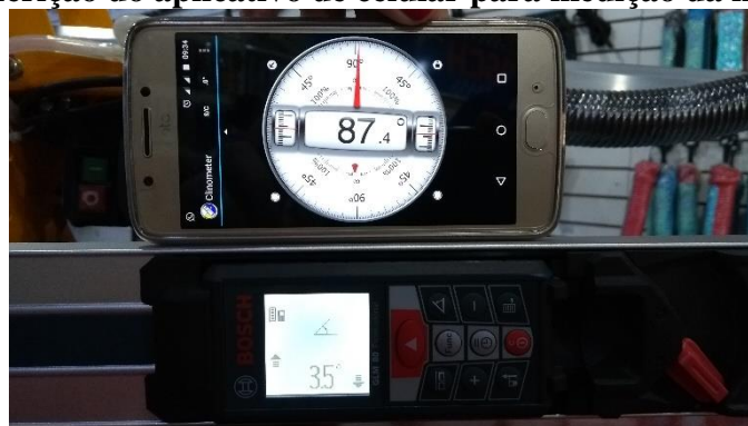
Figura 3.8 – Aferição do aplicativo de celular para medição da inclinação
