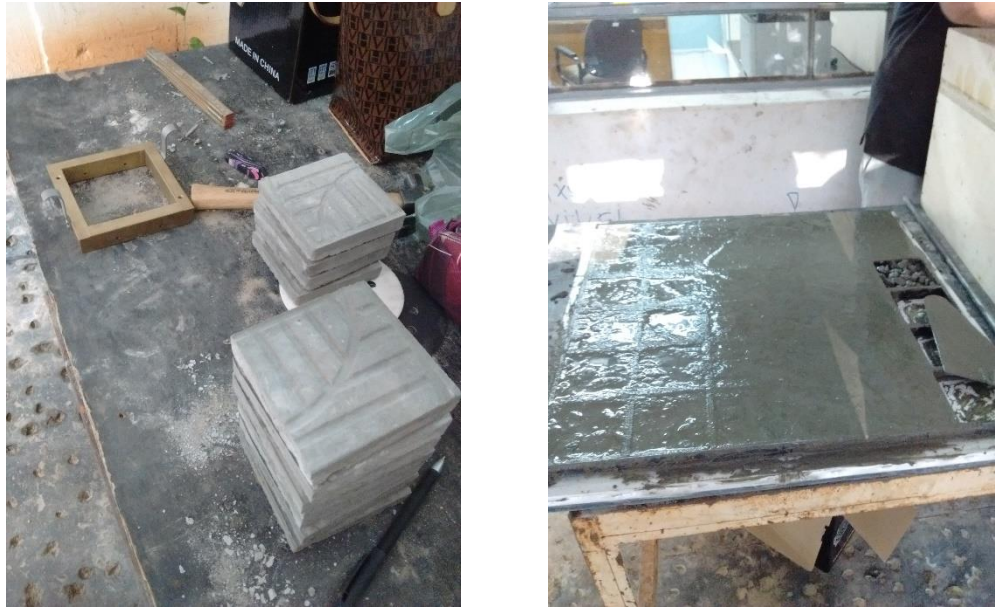
Figura 3.16– Produção dos corpos de prova de pavimento
