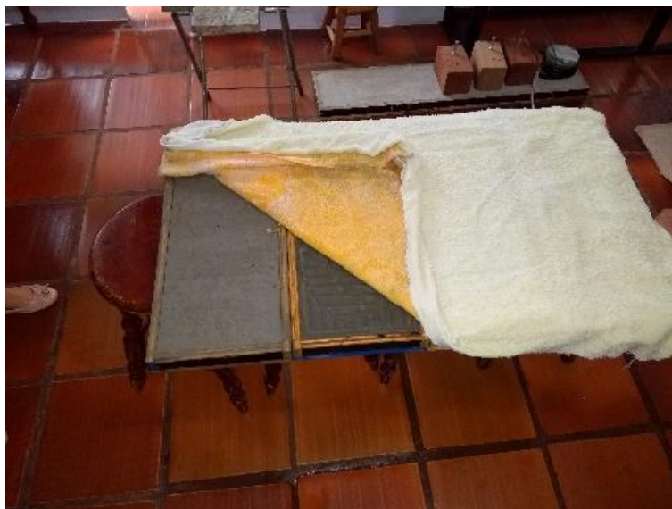
Figura 3.11 – Umedecimento dos revestimentos
