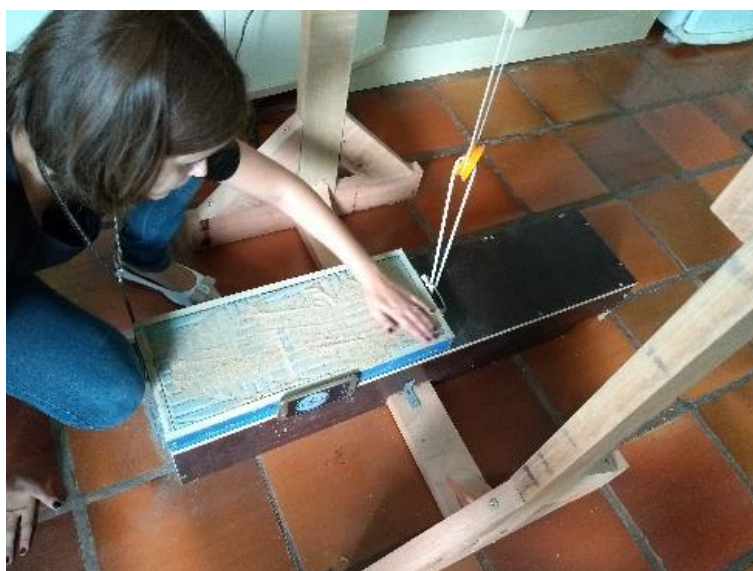
Figura 3.12 – Espalhamento manual da areia
