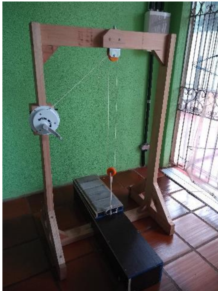
Figura 3.7 – Esquema de montagem do ensaio do Método de Inclinação da superfície
