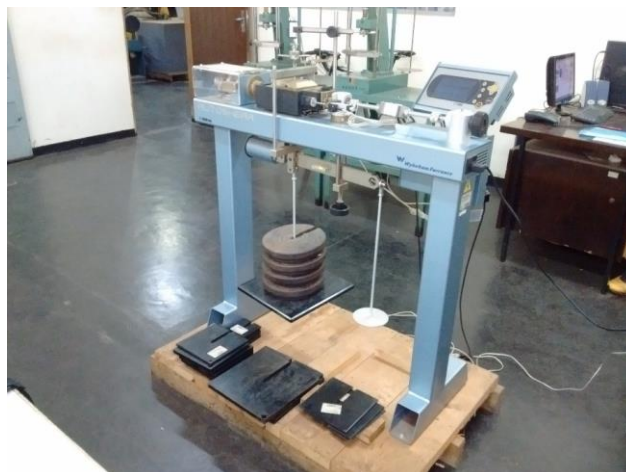
Figura 3.15 – Prensa de Cisalhamento Direto – Autosherr
