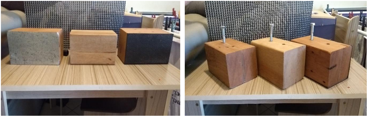
Figura 3.6 – Corpos de prova para o ensaio do Método de Inclinação da Superfície
