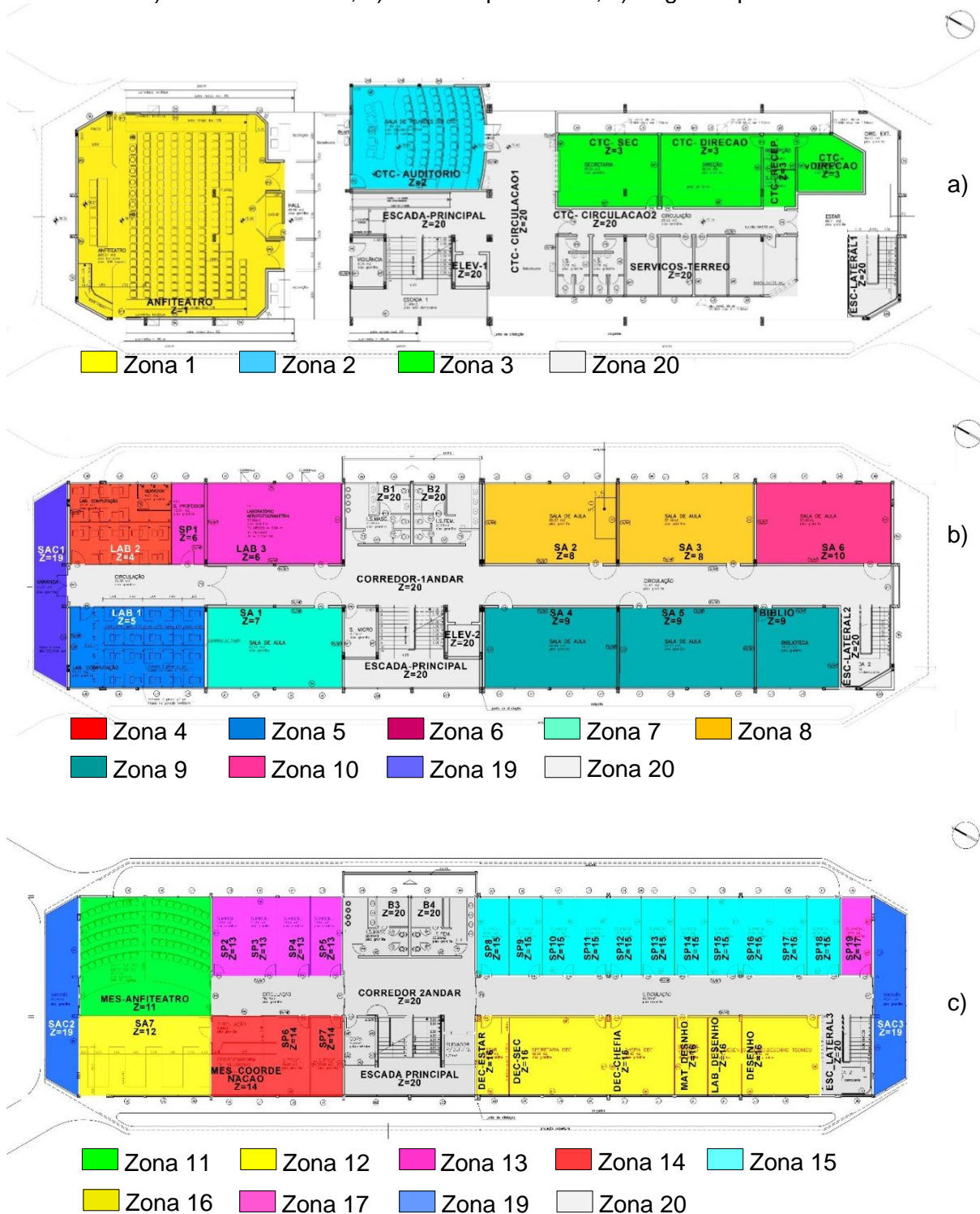
Figura 28 – Divisão das zonas de análise – Bloco C67 a) Pavimento térreo; b) Primeiro pavimento; c) Segundo pavimento.
